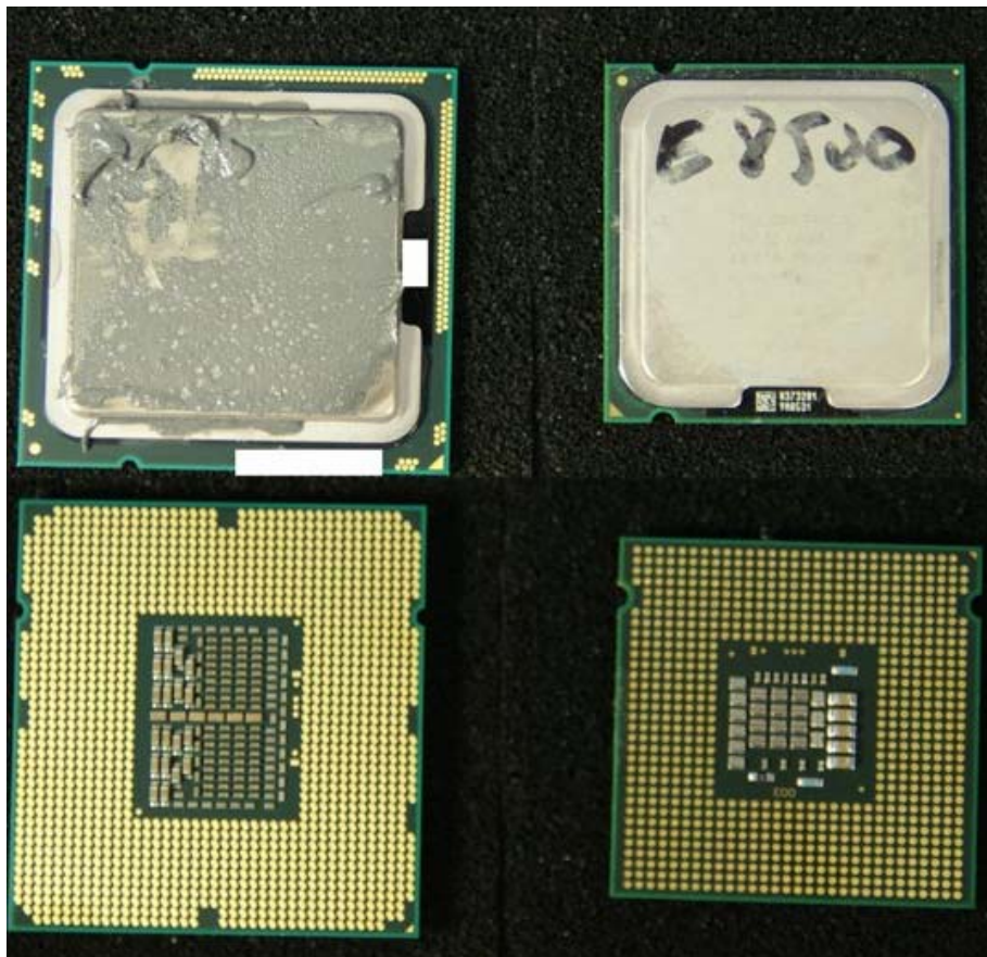
Obrázek číslo 1 : Porovnání mikroarchitektur Nehalem(vlevo) a Core(vpravo)
